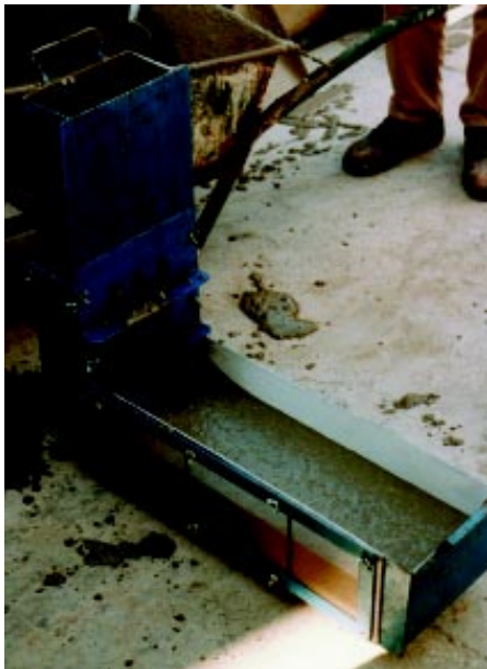
Ensayo de hormigón autocompactante
